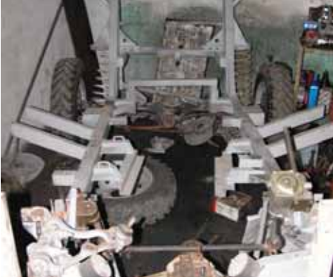
Şasi, 10 yıl aradan sonra kumlandı, kaynakları elden geçti. Ön ve arka diferansiyeller bağlandı. Niva-Böcek bir melez olarak yeniden doğuyordu artık.
