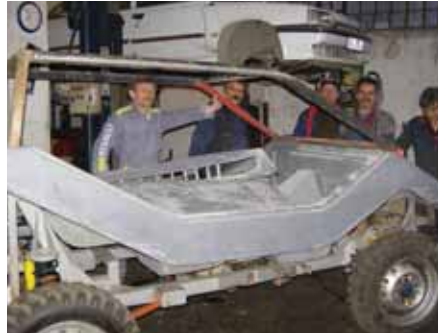
Nihayet "klon" kaporta, şasi üzerine konuldu. Böylece ortada dolaşan bilimum parça bir araya gelip otomobile benzer bir yapıya dönüştüler.
