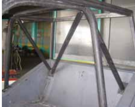
Niva-Böcek melezimiz –acaba Nöcek mi demeliyim?-için özel bir roll-cage tasarımı yapıldı.
