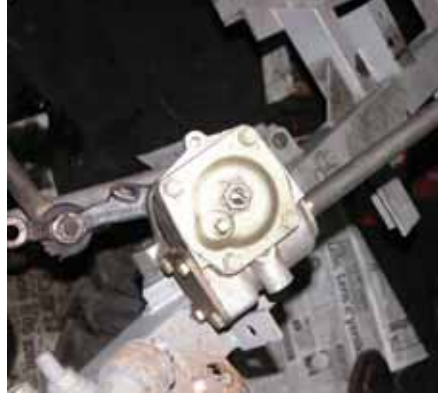
Şasi, 10 yıl aradan sonra kumlandı, kaynakları elden geçti. Ön ve arka diferansiyeller bağlandı. Niva-Böcek bir melez olarak yeniden doğuyordu artık.
