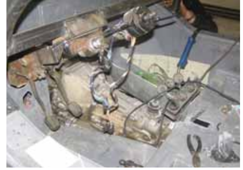
Direksiyon ve pedallar roll-cage üzerine bağlandı.
