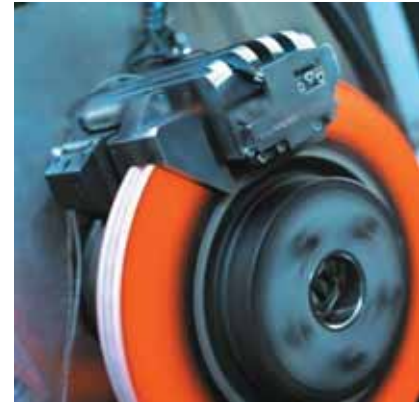
Siemens VDO elektrikli kama fren sistemini geliştirmekte ve fren test tezgahlarında kullanmakta.
